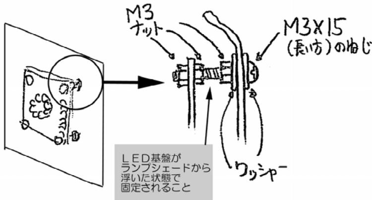
② LED基板と色を合わせて配線しよう。(実際の部品の位置に合わせてコードの長さを切断・・・きれいにできるように工夫したいですね)
